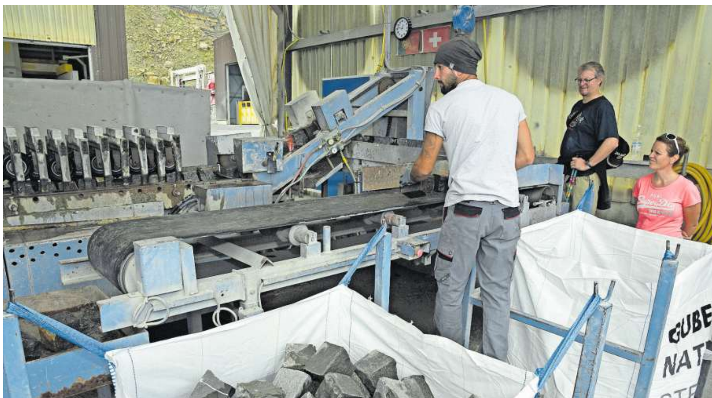
An diesem Arbeitsplatz werden Steine mit hoher Temperatur geflammt, damit die Oberflächen rollstuhltauglich werden, aber ihre Struktur trotzdem behalten. Besucher schauen interessiert zu. Bild: Robert Hess (Alpnach, 14. September 2019)
